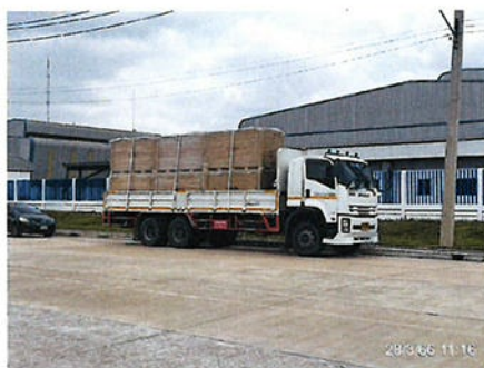
ภาพที่ 2-65 การปิดคลุมผูกมัดอุปกรณ์ในการขนส่ง
